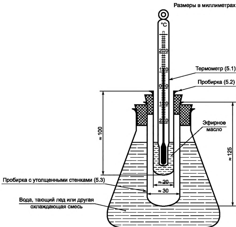
Рисунок — Подходящий прибор для определения температуры застывания
