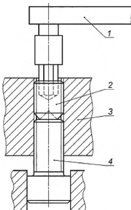
1 — гаечный ключ с ограничением по крутящему моменту; 2 — испытуемый установочный винт;
