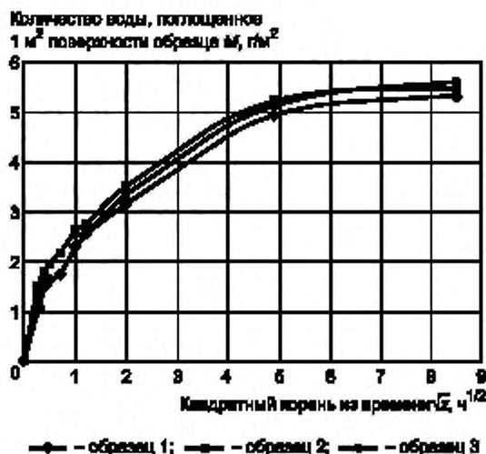
Рисунок А.1 — Графики капиллярного всасывания воды образцами
