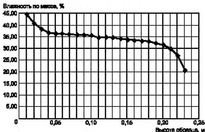
Рисунок А.1 — Распределение влажности по высоте образца
