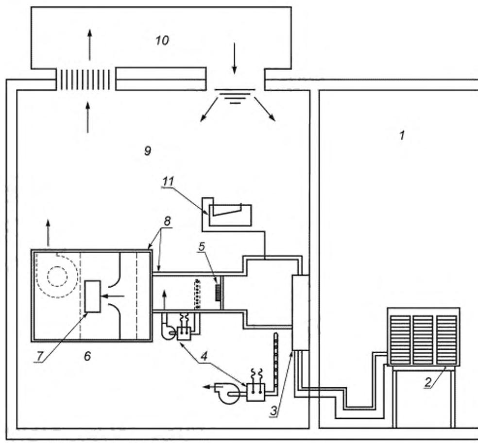
1 — отсек наружной стороны; 2 — наружный блок испытуемого оборудования; 3 — секция испытуемого оборудования с внутренним теплообменником; 4 — измерительные приборы температуры и влажности; 5 — смеситель; 6 — аппаратура измерения воздушного потока; 7 — дверь/окно; 8 — изоляция; 9 — отсек внутренней стороны; 10 — аппарат кондиционирования помещения; 11 — аппаратура для измерения перепада давления
