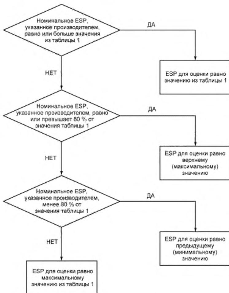
Рисунок 1 — Блок-схема выбора ESP для оценки
