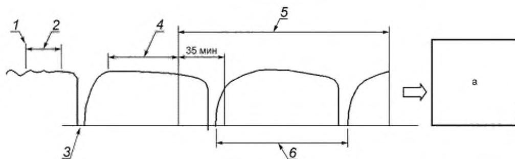
1 — достигнуто соответствие с допустимыми отклонениями испытания; 2 — период предварительной подготовки (минимально — 10 мин); 3 — размораживание в конце периода предварительной подготовки; 4 — период равновесия (60 мин); 5 — период сбора данных (3 ч); 6 — один полный цикл размораживания,  $\Delta t$  внутреннего воздуха; а — завершить испытание, когда период сбора данных равен 3 ч
