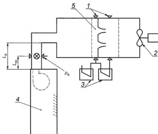
1 — аппарат измерения воздушного потока; 2 — вытяжной вентилятор; 3 — манометры; 4 — исследуемое оборудование; 5 — сопла;  $L_d$  — длина измерительного воздуховода;  $L_m$  — расстояние от отверстий для измерения статического давления;  $p_v$  — ESP исследуемого оборудования
