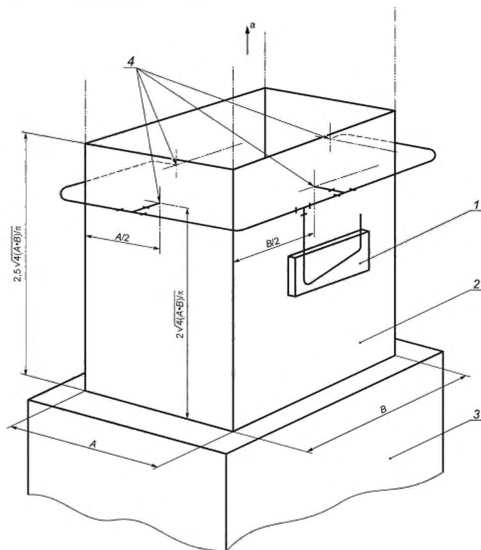
1 — манометр; 2 — выпускная камера; 3 — исследуемое оборудование; 4 — отверстия для измерения статического давления, а — к аппарату измерения воздушного потока
