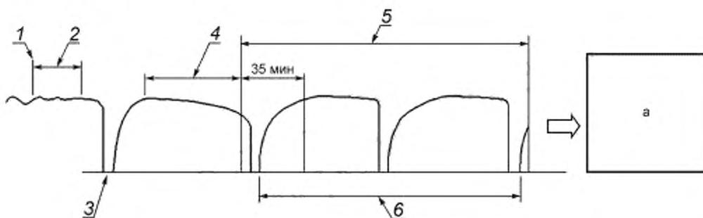
1 — достигнуто соответствие с допустимыми отклонениями испытания; 2 — период предварительной подготовки (минимально — 10 мин); 3 — размораживание в конце периода предварительной подготовки; 4 — период равновесия (60 мин); 5 — период сбора данных (3 ч); 6 — два полных цикла размораживания,  $\Delta t_{\text{внутреннего воздуха}}$ ; а — завершить испытание, когда период сбора данных равен 3 ч
