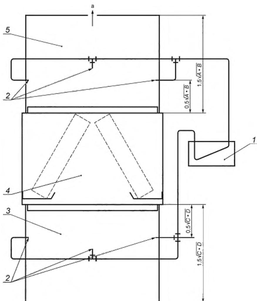
1 — манометр; 2 — отверстия для замера давления на выпуске; 3 — канал впуска; 4 — секция теплообменника; 5 — канал выпуска;  $A$  и  $B$  — размеры отверстия выпуска;  $C$  и  $D$  — размеры отверстия впуска;  $a$  — к аппарату измерения воздушного потока
