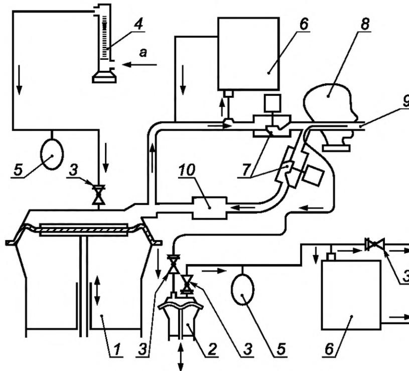
а — диоксид углерода; 1 — дыхательная машина; 2 — вспомогательное «легкое»; 3 — односторонний клапан;
