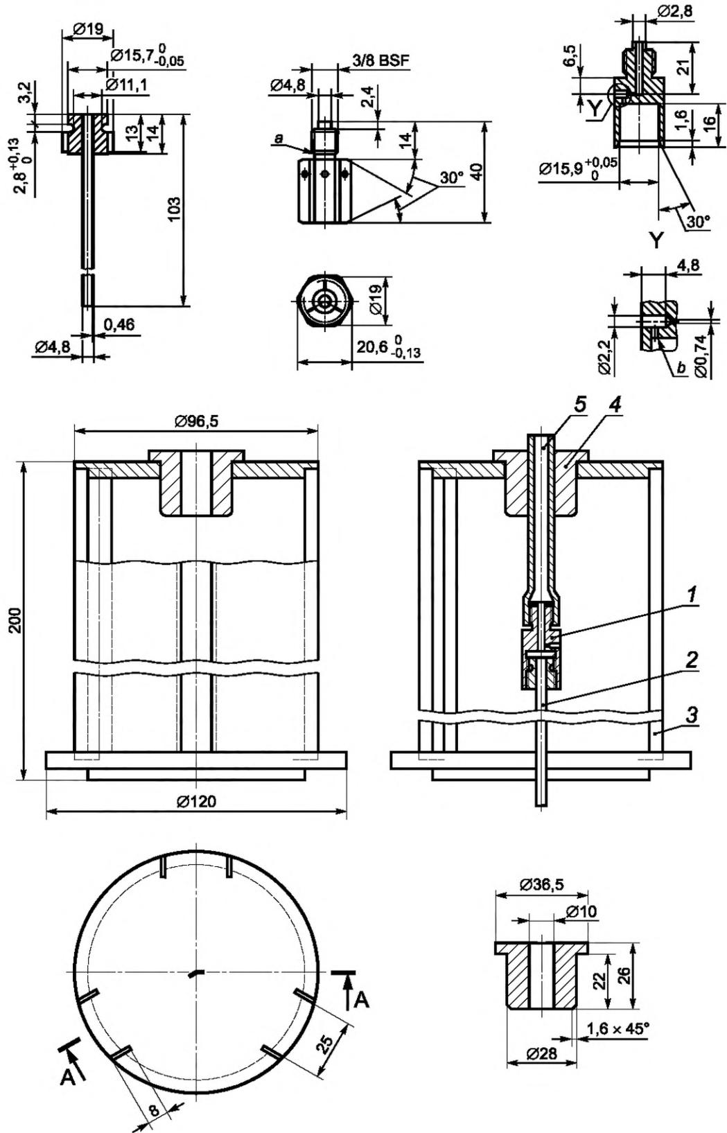
1 — сопло распылителя; 2 — трубка для подачи солевого раствора; 3 — рукав («отбойник частиц»);
