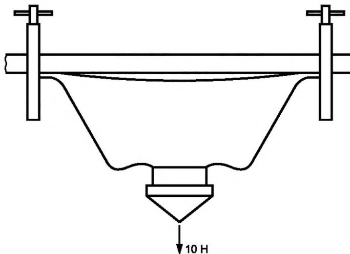
Рисунок 8 — Зажимное устройство для фильтрующей полумаски
