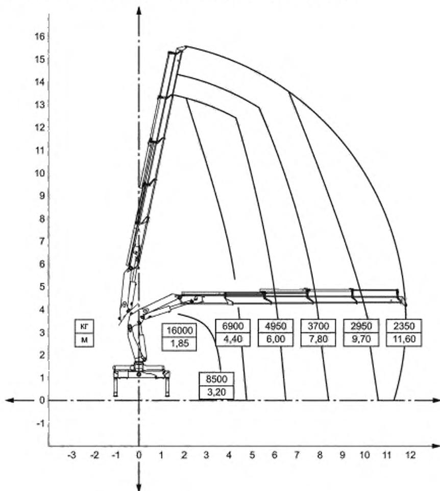
Рисунок 3 — Пример грузовой характеристики
