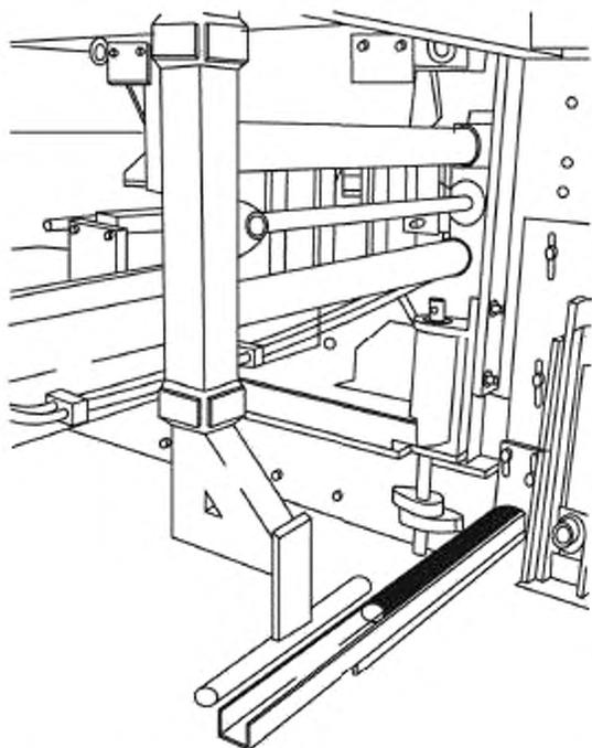
Рисунок А.4 — Механизм для укладки продольных стягивающих арматурных стержней:
