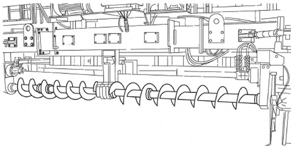
Рисунок А.7 — Типовой распределительный шнек бетоноукладчика
