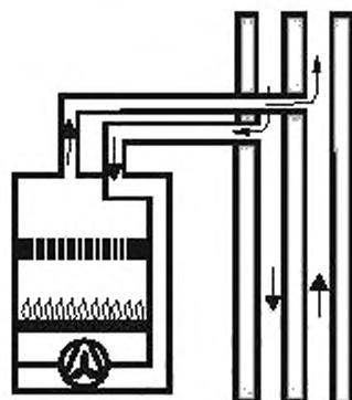
c) C<sub>43</sub>Рисунок D.4 — Тип C<sub>4</sub>
