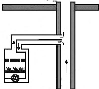
в) C<sub>23</sub>Рисунок D.2 — Тип C<sub>2</sub>
