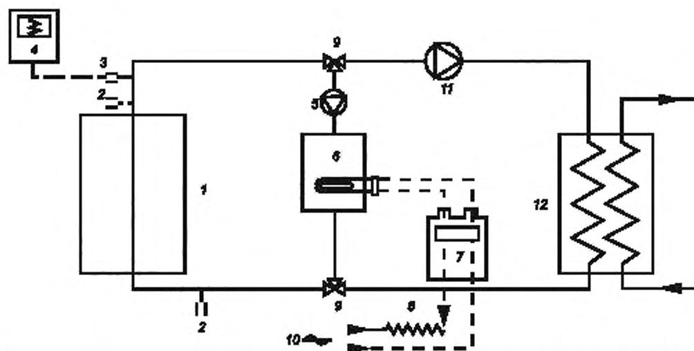
1 - испытуемый котел, 2 - датчик температуры, 3 - низкоинерционный термоэлемент; 4 - записывающее устройство; 5 - насос (обеспечивает перепад температур между обоими термоматчиками в пределах  $2\text{ }^{\circ}\text{C} - 4\text{ }^{\circ}\text{C}$  от максимальной испытательной температуры); 6 - электрический водонагреватель; 7 - электросчетчик; 8 - регулятор напряжения, 9 - клапан на  $1/4$  поворота, 10 - электролитание. 11 - вспомогательный насос (при необходимости); 12 - теплообменник
