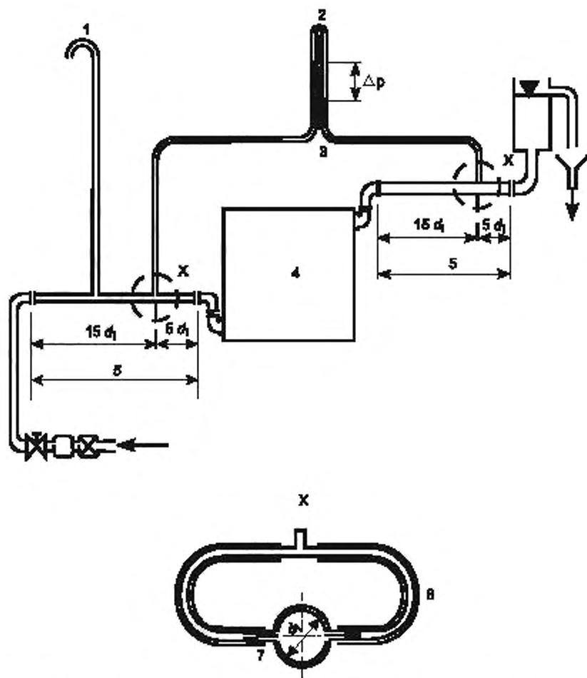
1 - труба для сброса воздуха. 2 - дифференциальный манометр; 3 - гибкие трубки; 4 - котел; 5 - испытательная труба;
