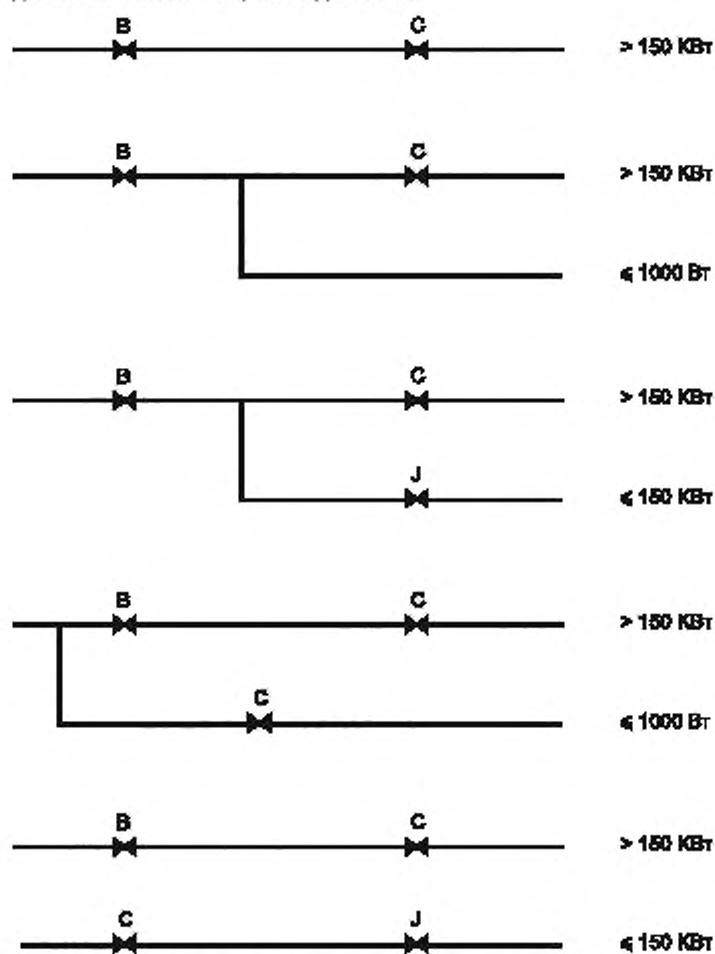
Рисунок Н.2 — Подводимая тепловая мощность до 300 кВт
