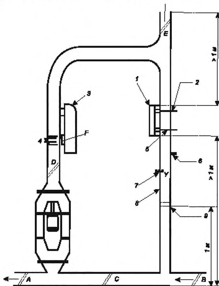
1 - испытуемый котел; 2 - к анализаторам СО и  $CO_2$ ; 3 - нагреватель воды; 4 - теплообменник; 5 - подсоединение к анализаторам СО и  $CO_2$  для испытаний восходящего потока; 6 - датчик давления; 7 - датчик температуры; 8 - дымоход прямоугольного сечения  $1250 \times Q$ , мм<sup>2</sup>; 9 - записывающие анемометры (2 шт.); взаимозаменяемые
