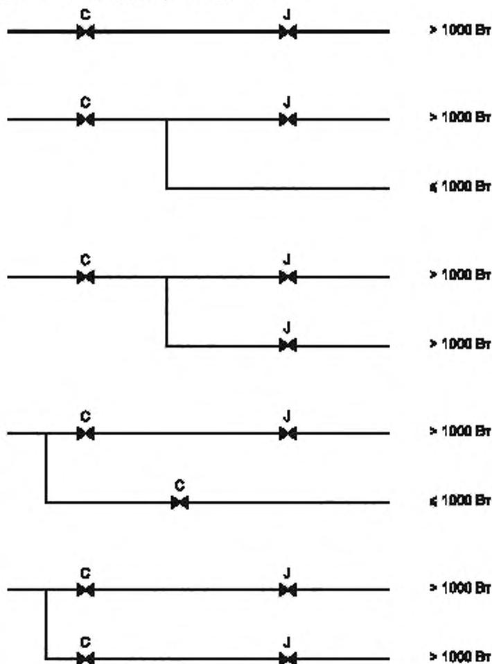
Рисунок Н.1 — Подводимая тепловая мощность до 150 кВт
