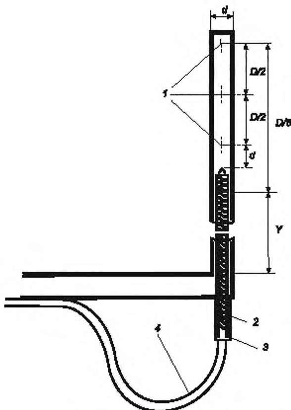
1 – отверстия для отбора проб; 2 – керамическая труба с двумя каналами; 3 – изолирующий цемент;
