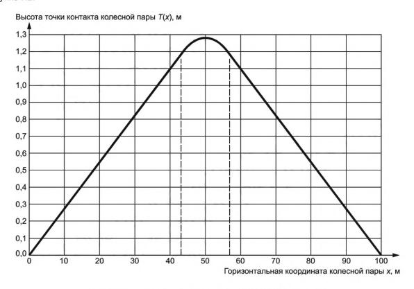
Рисунок Г.2 — График высоты точек контактов колесных пар
