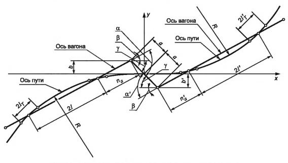
Рисунок 8.1 — Расчетная схема прохода сцепом вагонов кривых
