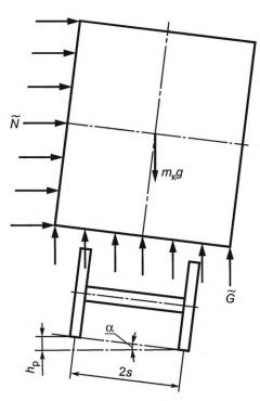
$\widetilde{N}$  — распределенная по боковой поверхности контейнера горизонтальная составляющая силы N, кН/м²;  $\widetilde{G}$  — распределенная по нижней поверхности контейнера вертикальная составляющая силы G, кН/м²;  $m_{\rm K}$  — минимальная расчетная масса контейнера, кг;  $h_{\rm p}$  — возвышение наружного рельса в кривой, м; 2s — расстояние между кругами катания колес в кривой, м;  $\alpha$  — угол наклона вагона в кривой, равный  $5,36^\circ$ ; g — ускорение свободного падения, м/с²
