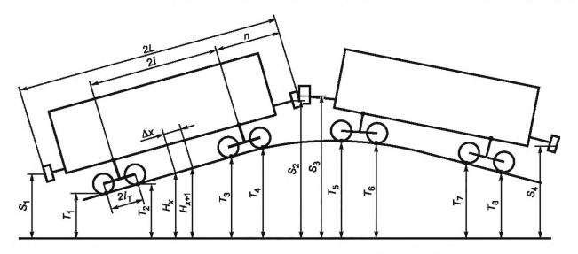
2L — длина вагона по осям сцепления автосцепок, м. Для вагона сочлененного типа принимают 2L — длина секции вагона от центра пятника над устройством сочленения до оси сцепления автосцепок;
