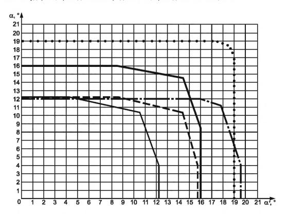
Рисунок 8.2 — Ограничительные контуры для автосцепки модели CA-3 по ГОСТ 32885, установленные по ГОСТ 3475
