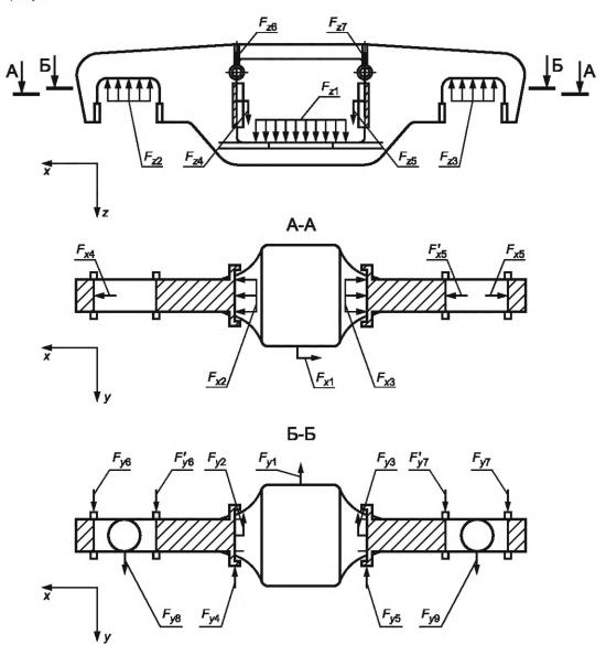
Рисунок А.1 — Схема сил, действующих на боковую раму
