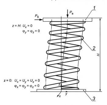
$U_{x'}$   $U_{y'}$   $U_{z}$  — перемещение опорных тел вдоль осей x, y и z;  $\phi_{x'}$   $\phi_{y'}$ ,  $\phi_{z}$  — угол поворота опорных тел относительно осей x, y и z;  $P_{\rm B}$ ,  $P_{\rm G}$  — вертикальная и боковая силы, действующие на пружину; H — высота пружины с учетом толщины нижнего и верхнего опорных тел; 1 — верхнее опорное тело; 2 — пружина; 3 — нижнее опорное тело
