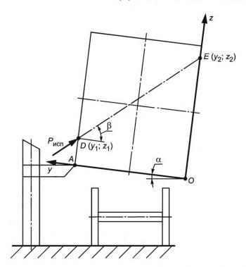
$P_{\text{исп}}$  — испытательная сила, кH;  $\alpha$  — угол наклона рамы вагона, соответствующий углу наклона вагона в кривой, градусы;  $\beta$  — угол, определяющий направление линии действия испытательной силы, градусы; AD — расстояние от нижней грани контейнера до точки приложения сжимающей испытательной силы, м; OE — расстояние от нижней грани контейнера до точки приложения растягивающей испытательной силы, м
