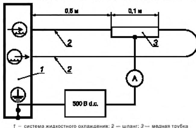
1 — система жидкостного охлаждения; 2 — шланг; 3 — медная трубка
