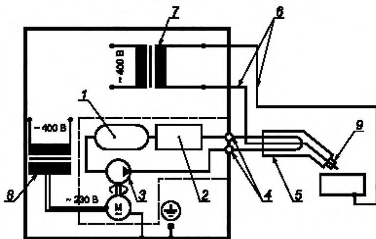
1 — бак; 2 — теплообменник; 3 — насос; 4 — заземленные трубы подачи охлаждающей жидкости; 5 — горелка; 6 — сварочный контур; 7 — сварочный трансформатор; 8 — трансформатор; 9 — контактный наконечник
