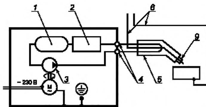
1 — бак; 2 — теплообменник; 3 — насос; 4 — заземленные трубы подачи охлаждающей жидкости; 5 — горелка; 6 — сварочный контур; 9 — контактный наконечник
