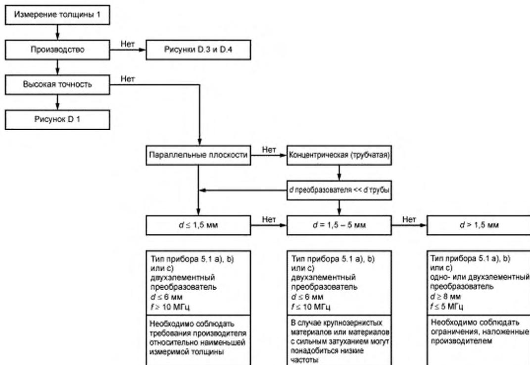
Рисунок D.2 — Блок-схема контроля в процессе производства
