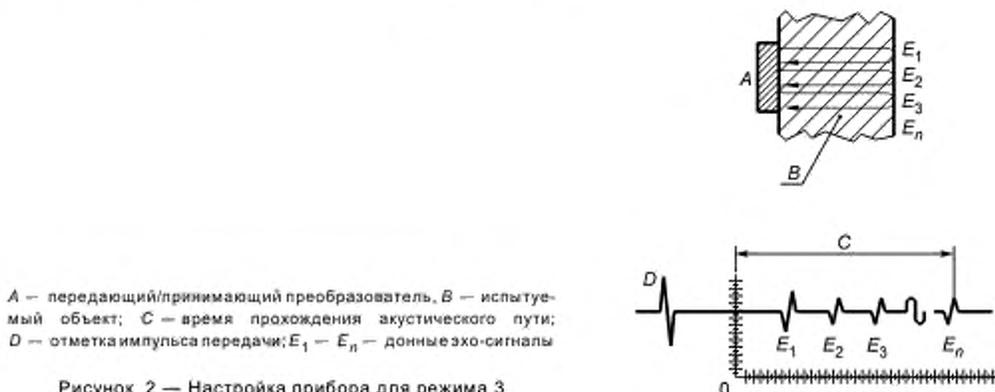
А — передающий/принимающий преобразователь, В — испытуемый объект; С — время прохождения акустического пути; D — отметка импульса передачи;  $E_1 - E_n$  — донные эхо-сигналы
