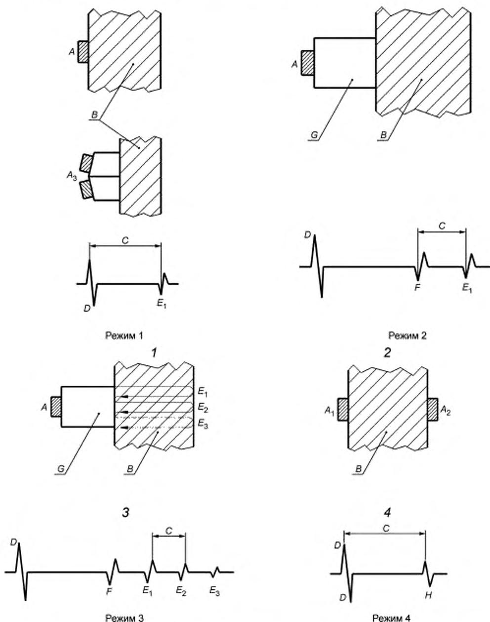
*A* — передающий/принимающий преобразователь; *A<sub>1</sub>* — передающий преобразователь; *A<sub>2</sub>* — принимающий преобразователь; *A<sub>3</sub>* — раздельно-совмещенный преобразователь; *B* — испытуемый объект; *C* — время прохождения акустического пути; *D* — отметка импульса передачи; *E<sub>1</sub>–E<sub>3</sub>* — донные эхо-сигналы, *F* — эхо-сигнал от границы раздела, *G* — задержка, *H* — принятый импульс
