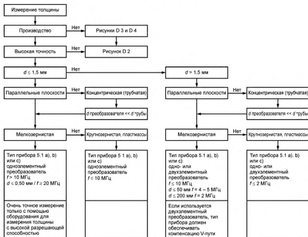
Рисунок D.1 — Блок-схема контроля в процессе производства
