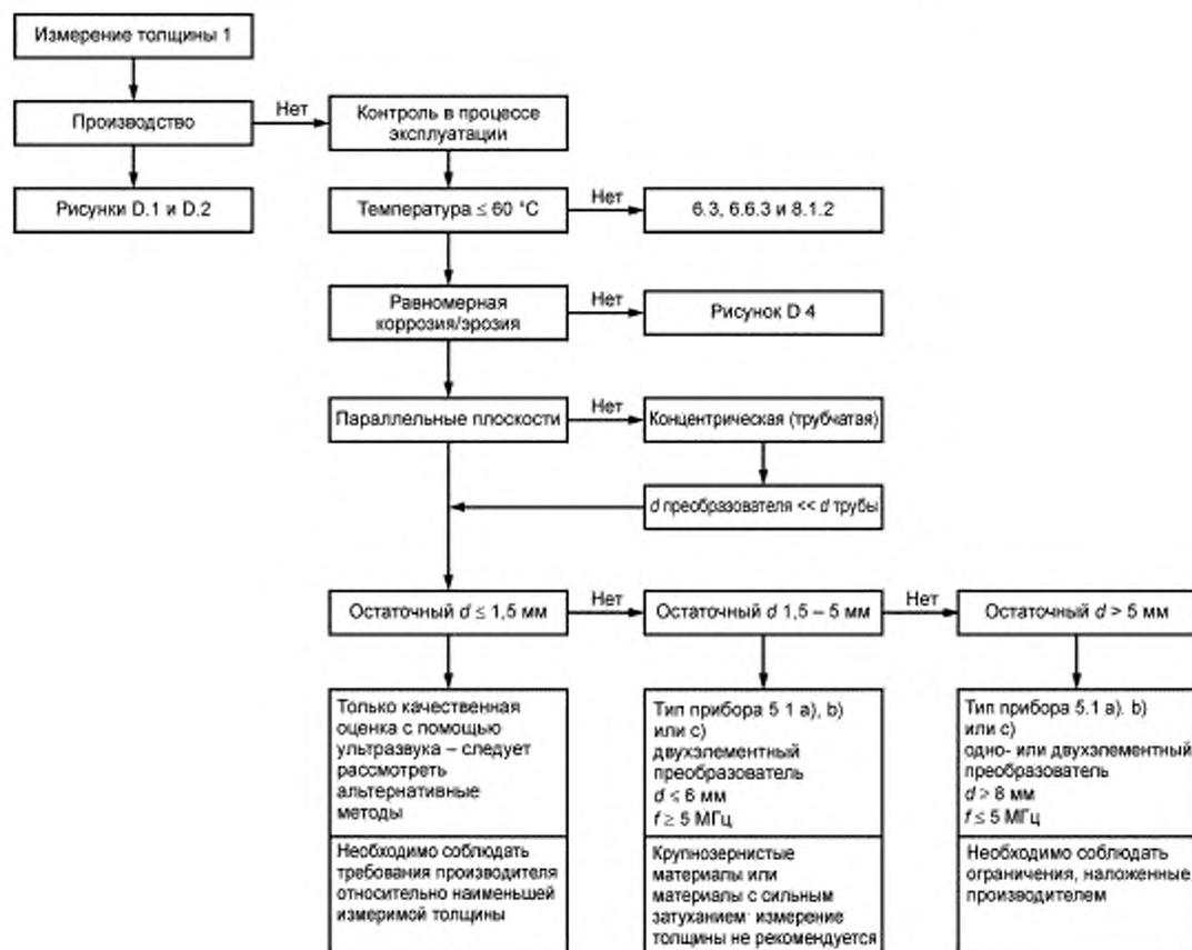
Рисунок D.3 — Блок-схема контроля в процессе эксплуатации
