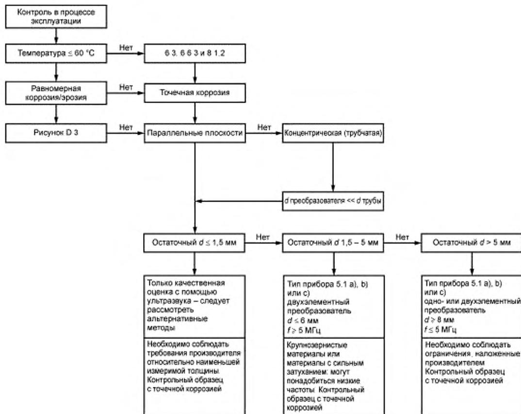
Рисунок D.4 — Блок-схема контроля в процессе эксплуатации
