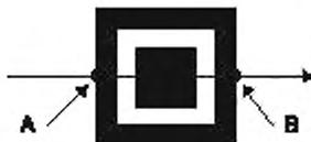
Рисунок 31 – Линия сканирования в шаблоне поиска
