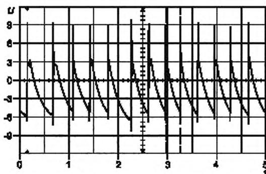
Рисунок А.2 — Типичные осциллограммы напряжения, генерируемого искровым разрядником ( $U$ , кВ;  $t$ , мс)
