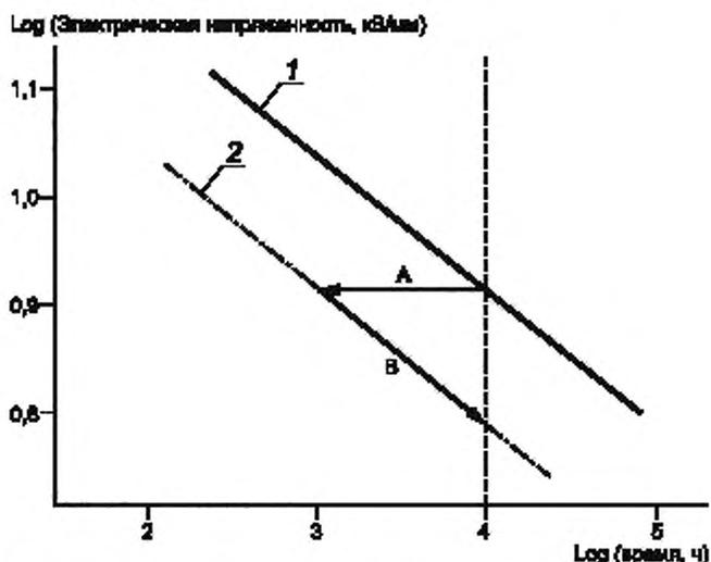
1 — зависимость, полученная по результатам испытаний при повышенном напряжении промышленной частоты,
