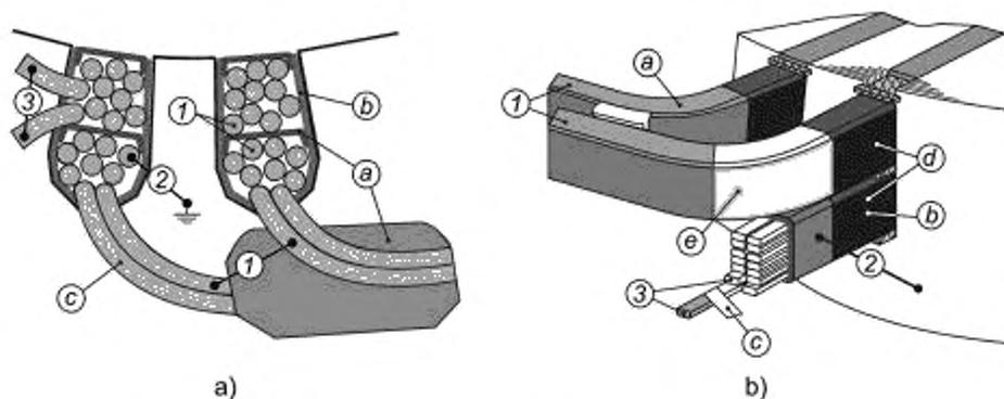
*a* — фазная изоляция (межслойная); *b* — изоляция на землю; *c* — витковая изоляция; *d* — система защиты от короны в лагу; *e* — система выравнивания напряженности электрического поля; 1 — межфазная изоляция; 2 — изоляция «фаза—земля»; 3 — межвитковая изоляция
