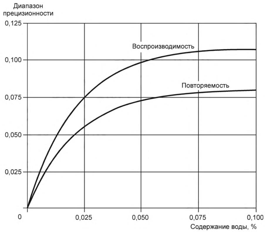
Рисунок 1 — Прецизионность метода определения воды в нефти в пределах от 0,0 % до 0,1 %
