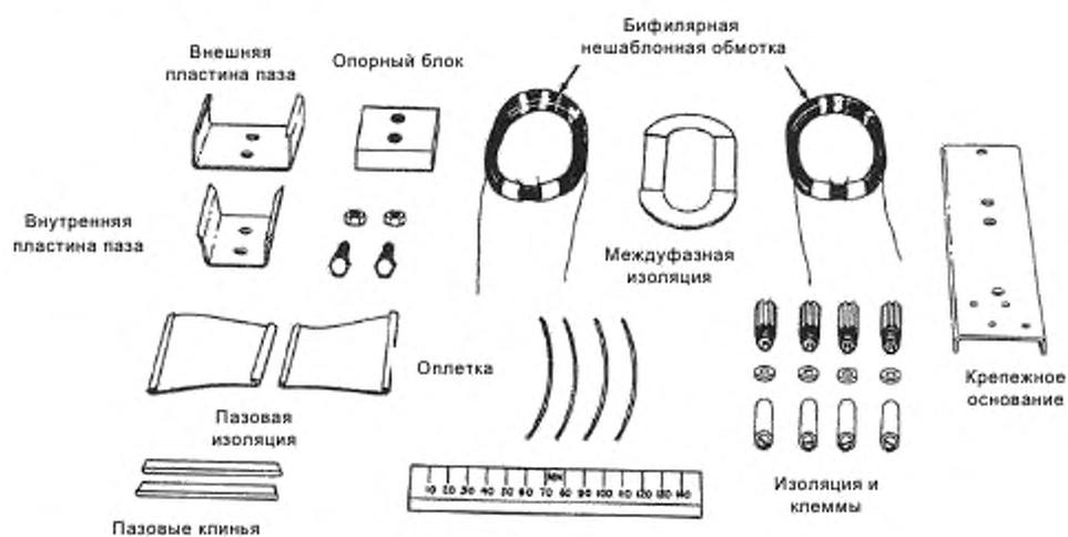
Рисунок А.1 — Компоненты модели перед окончательным монтажом
