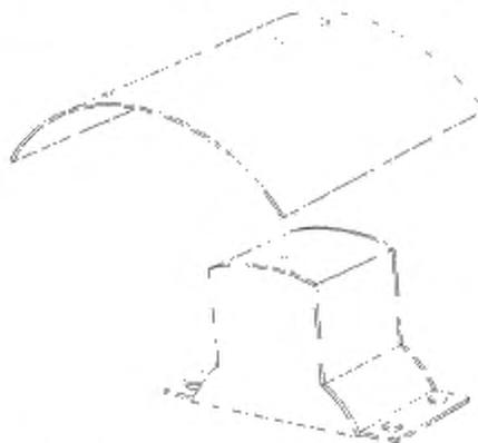
Рисунок В.1 — Испытательная арматура для нешаблонной обмотки
