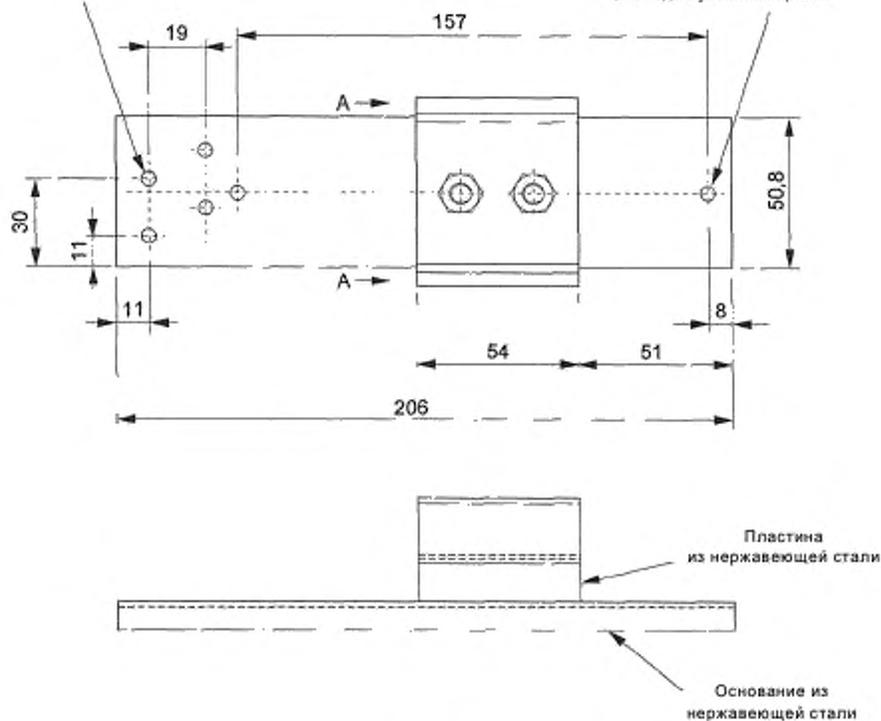
Шестигранные болты и гайки из нержавеющей стали
