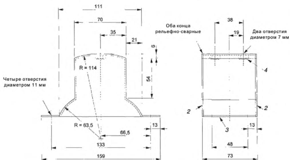
2, 3 – материал толщиной 1,6 мм; 4 – 6×1 шестигранные стальные (должны быть две) рельефно-сварные гайки к 3
