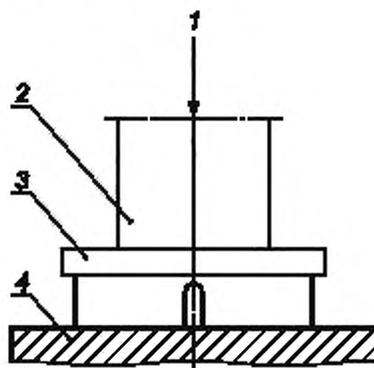
1 — направление приложения нагрузки; 2 — плунжер; 3 — образец; 4 — нагревательная плита
