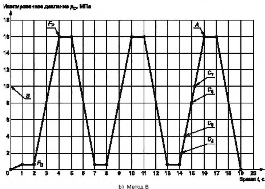
$F_B$  — предварительная нагрузка, МПа;  $F_P$  — испытательная нагрузка, МПа;  $A$  — точка снятия показаний;  $B$  — альтернативное испытательное давление 10 МПа (100 бар) (см. 5.3);  $C_1, C_2, C_3, C_4, C_5, C_6, C_7$  — дополнительные точки измерения (только для колодок в сборе)
