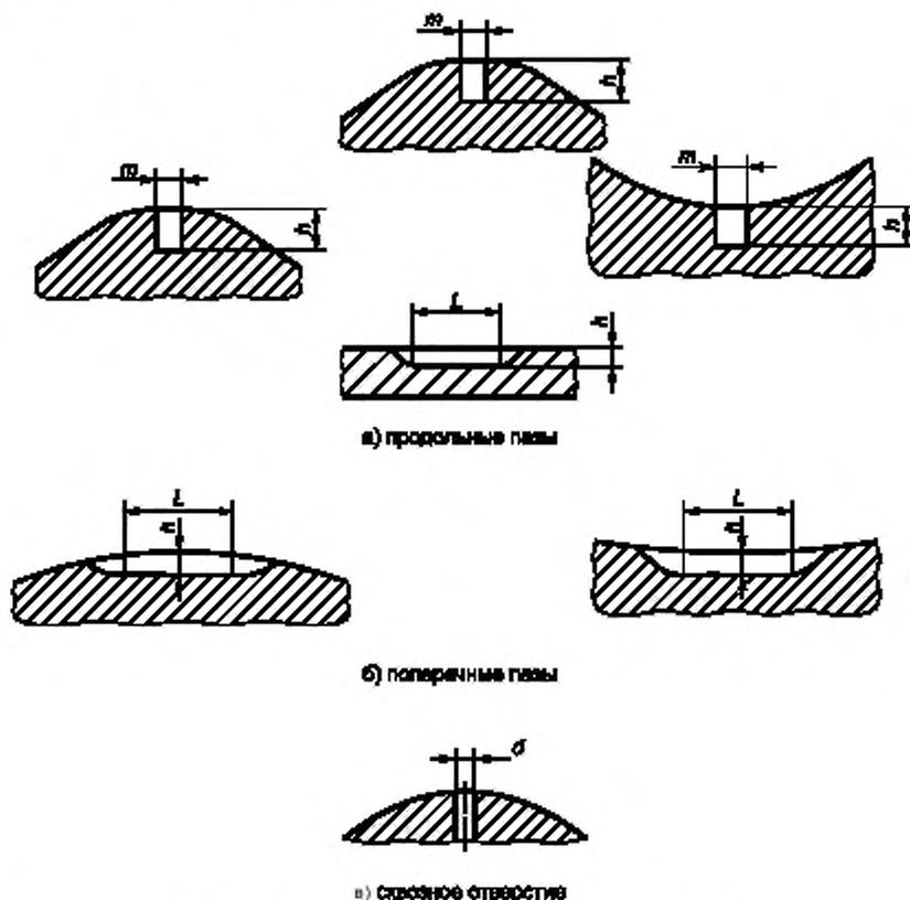
$h$  — глубина паза, равная  $(10 \pm 1,5)$  % от толщины стенки, но не менее 0,3 мм;  $L$  — длина на полной глубине 50 мм,
