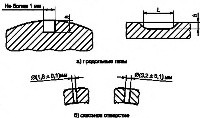
$h$  — глубина паза, равная  $(5 \pm 1,5)$  % или  $(10 \pm 1,5)$  % от толщины стенки, но не менее 0,3 мм;  $L$  — длина на полной глубине 50 мм
