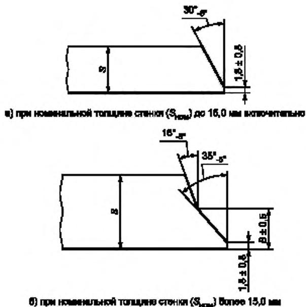
Рисунок 1 — Форма и размеры разделки торцов труб
