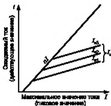
$I_{n1}, I_{n2}, I_{n3}$  — номинальные токи плавких вставок;  $I_c$  — максимальное значение пропускаемого тока;  $n$  — коэффициент, зависящий от значения коэффициента мощности;  $nI$  — асимметричное короткое замыкание
