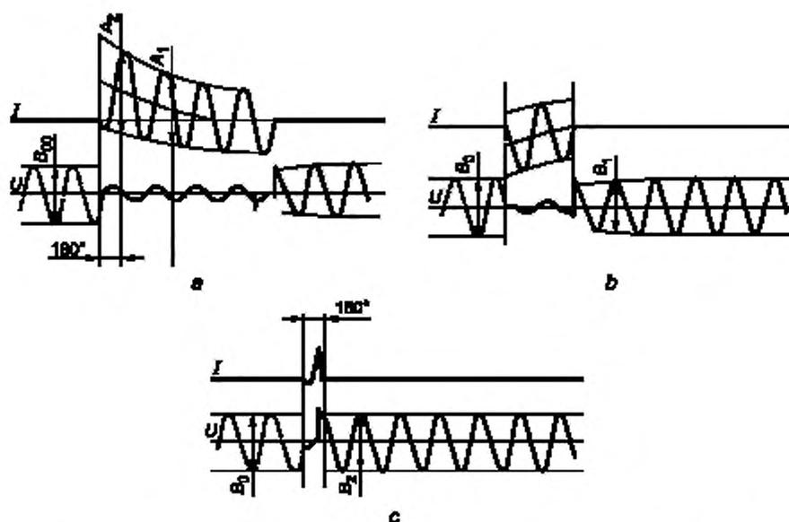
*a* – осциллограмма при калибровке цепи; *b* – осциллограмма отключения при образовании дуги после  $180^\circ$  с момента включения; *c* – осциллограмма отключения при образовании дуги до  $180^\circ$  с момента включения;
