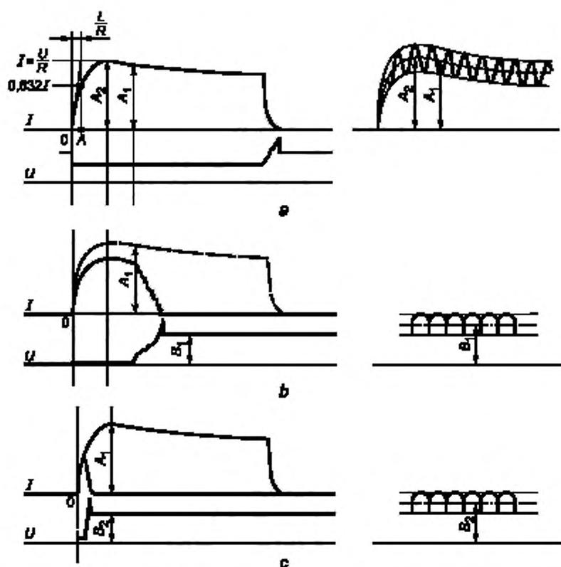
*a* — осциллограмма при калибровке цепи. При наличии пульсации следует измерить значения, соответствующие  $0,632 I$ ;  $A_1$  и  $A_2$  на кривой действующих значений; *b*, *c* — осциллограммы отключения при начале образования дуги соответственно после и до достижения током максимального значения.
