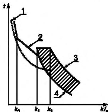
1 — времятоковая характеристика отключения подсоединенного коммутационного аппарата для защиты от сверхтоков;
