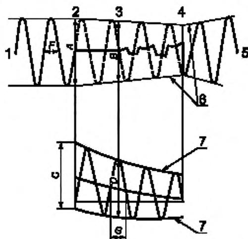
1 — напряжение до включения; 2 — короткое замыкание; 3 — начало образования дуги;
