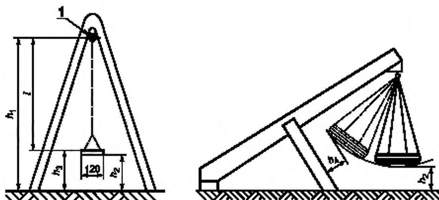
1 — ось вращения элемента подвеса (шарнир);  $h_1$  — высота качелей;  $h_2$  — расстояние до поверхности игровой площадки;
