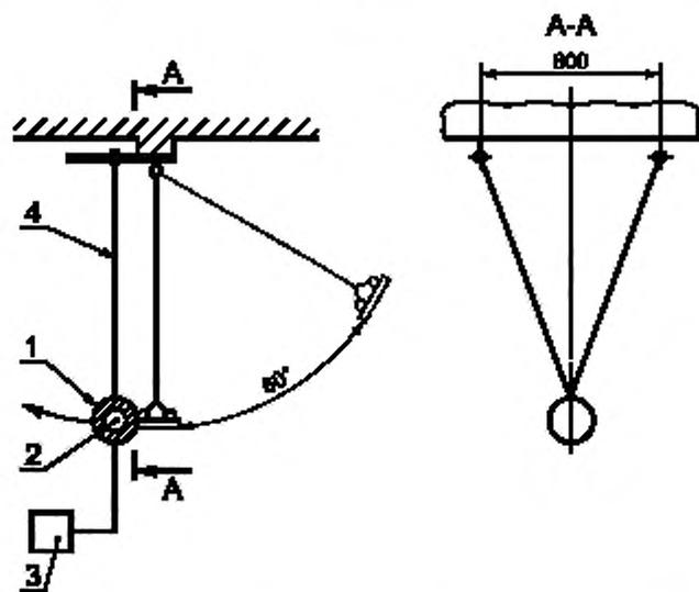
1 — испытательная масса; 2 — акселерометр; 3 — измерительное устройство;
