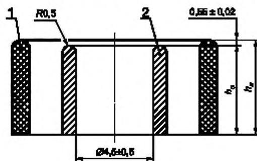
1 — сменная подложка для очковых линз высотой  $h_c$ ; 2 — подложка для контактных линз высотой  $h_k$
