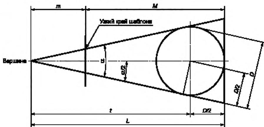
Рисунок Д.3 — Геометрические соотношения для V-образного шаблона
