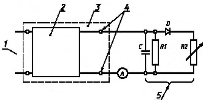
1 — сеть; 2 — ПРА, трансформатор, зажигающее устройство, 3 — светильник;
