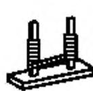
Рисунок 19 — Примеры безвинтовых соединений
