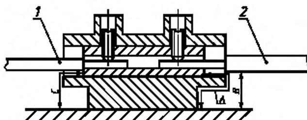
A — путь утчки; B — воздушный зазор (сетевой провод); C — воздушный зазор (провод внутреннего монтажа); 1 — провод внутреннего монтажа; 2 — сетевой провод
