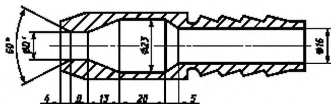
$D' = 6,3$  мм для испытания по пункту 9.2.6 (вторая цифра в обозначении степени защиты 5),  $D' = 12,5$  мм для испытания по пункту 9.2.7 (вторая цифра в обозначении степени защиты 5)
