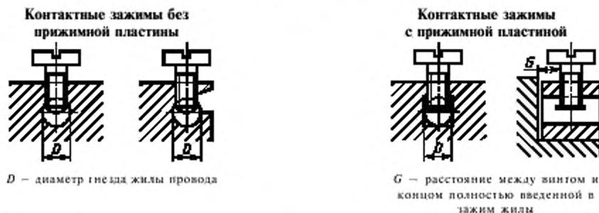
$D$  — диаметр гнезда жилы провода
