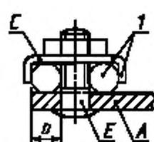
Контактные зажимы с крепежным винтом
