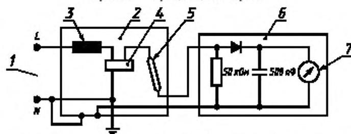
1 – сеть; 2 – выключатель; 3 – ПРА; 4 – ИЗУ; 5 – лампа; 6 – измерительное устройство; 7 – высоковольтный вольтметр
