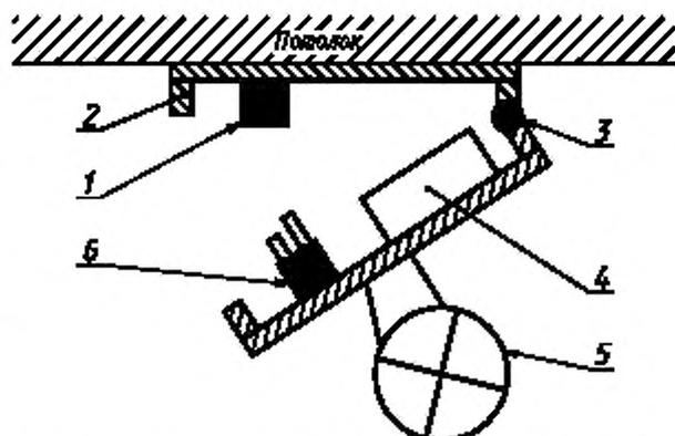
1 — штепсельная соединительная розетка, подключаемая к питающей сети; 2 — основная часть светильника (основание); 3 — шарнирное соединение, обеспечивающее легкое отделение секций светильника с блоком управления от основной части светильника (основания); 4 — устройство управления лампой; 5 — лампа; 6 — штепсельная соединительная вилка
