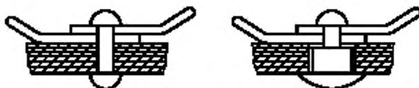
Рисунок 17 — Конструкция неразъемных соединений
