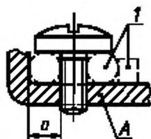
Винт, требующий шайбу или прижимную пластину
