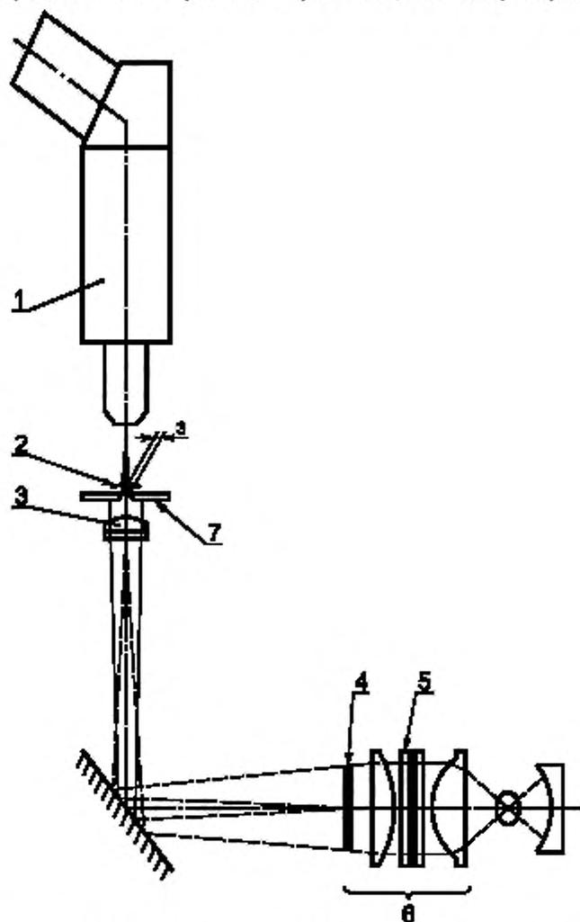
1 — микроскоп; 2 — ИОЛ; 3 — коллиматор; 4 — шкала USAF; 5 — дихроичный фильтр;
