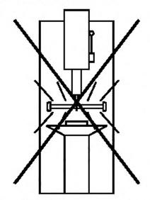
Рисунок А.2 — Сверлильный станок с открытой люминесцентной лампой, создающей блики
