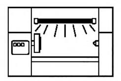
Рисунок А.5 — Токарный станок с флуореспентной лампой в закрытом светильнике. Легко протираемая защитная труба предохраняет лампу от грязи и поломки
