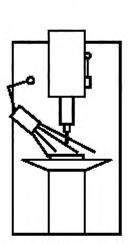
Рисунок А.1 — Сверлильный станок с освещением без бликов
