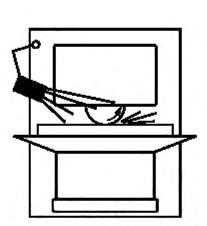
Рисунок А.3 — Шлифовальный станок с освещением с одной стороны. Правильное расположение светильника предотвращает чрезмерное загрязнение
