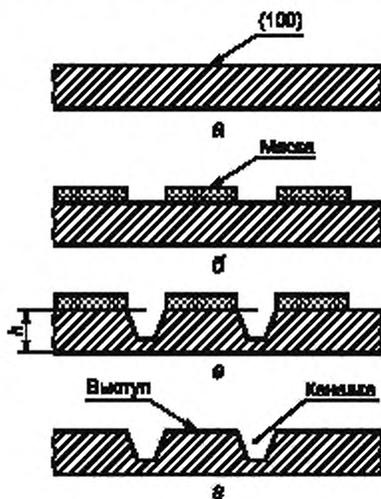
а — исходная пластина монокристаллического кремния с ориентацией поверхности {100}, б — пластина с нанесенной технологической защитой (маской); в — пластина после анизотропного травления,  $h$  — глубина травления; г — пластина после удаления технологической защиты с элементами рельефа
