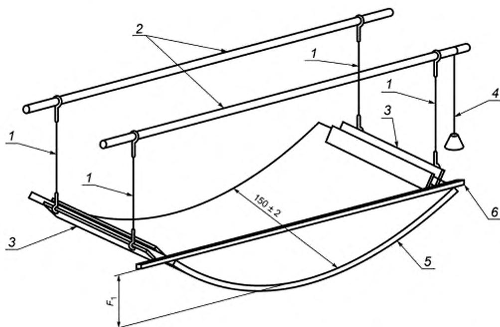
1 — четыре стальных несущих троса; 2 — две жесткие горизонтальные балки; 3 — два зажима; 4 — шнуровой отвес;
