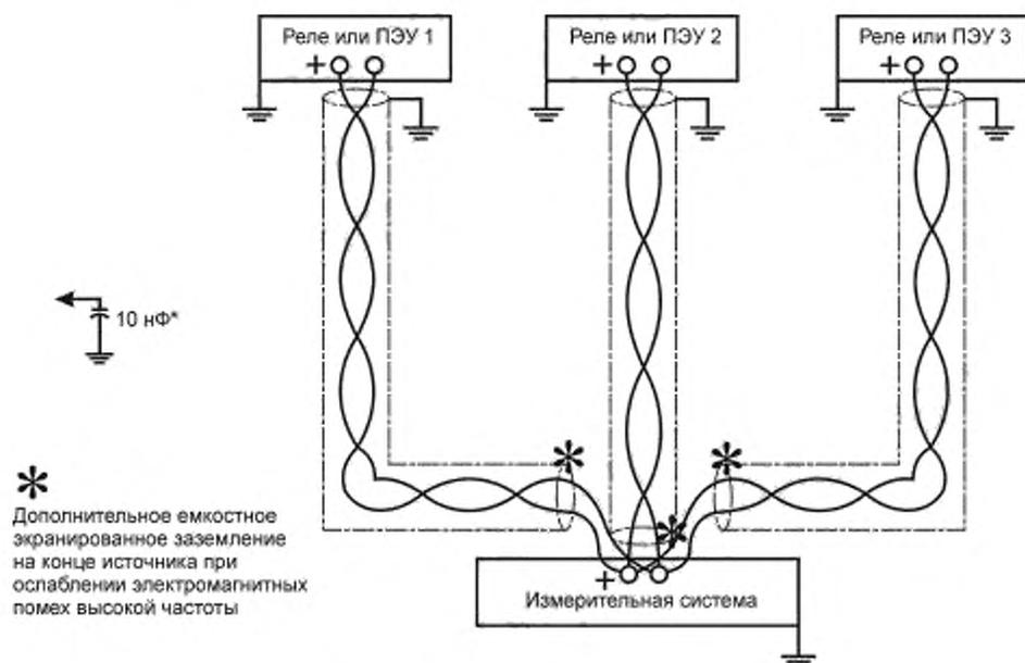
Рисунок 3 — Одна измерительная система с несколькими входами реле
