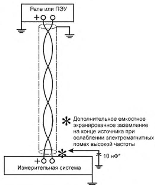
Рисунок 2 — Одна измерительная система и один вход реле
