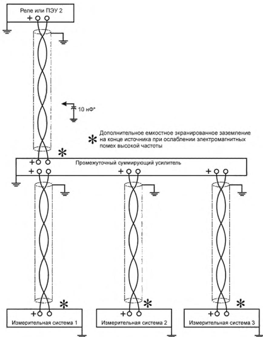
Рисунок 4 — Несколько измерительных систем и промежуточное устройство
