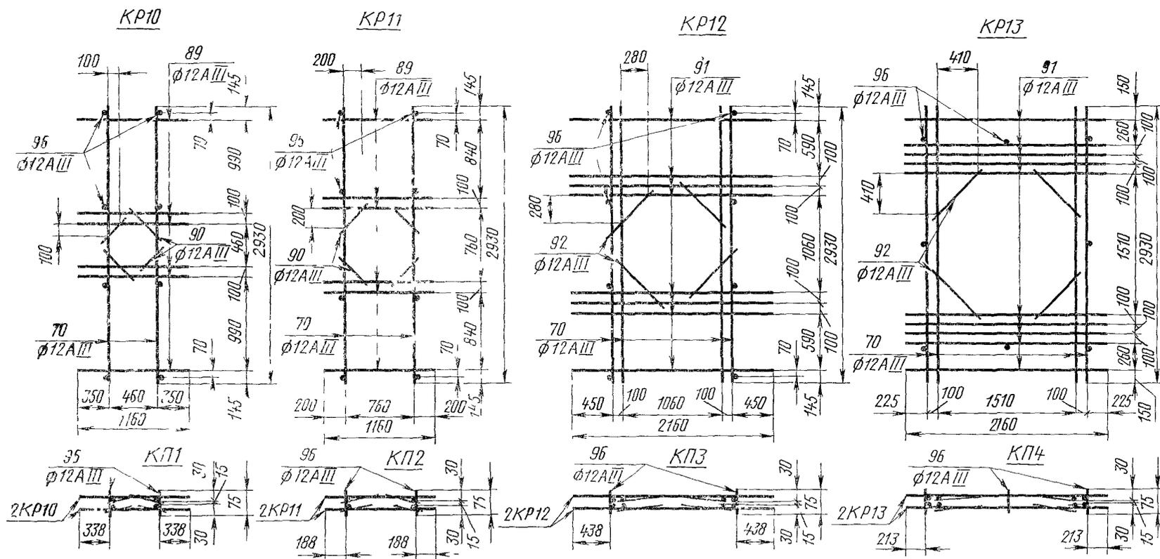
Поз. 96 на чертежах плоских каркасов КР10—КР13 показана условно
