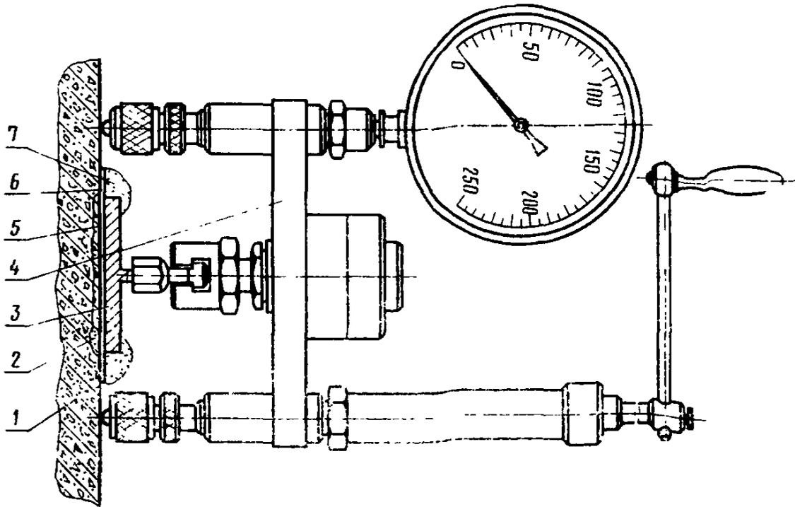
1 — испытываемая конструкция; 2 — отрываемый бетон; 3 — стальной диск; 4 — прибор ГПНВ-5; 5 — клей; 6 — бумажное кольцо; 7 — гипсовый раствор
