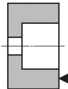
Рисунок 2 — Торцевое шлифование
