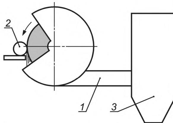
1 — отсос; 2 — обрабатываемая деталь; 3 — система сбора влажного типа
