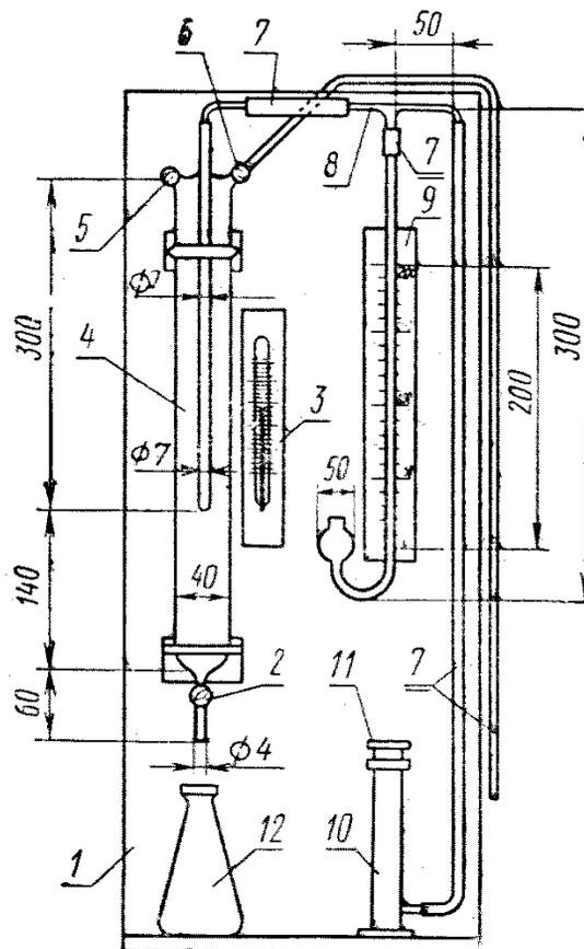
1 — деревянный штатив; 2, 5, 6 — краны; 3 — термометр; 4 — стеклянный аспиратор; 7 — резиновые трубки; 8 — стеклянный тройник; 9 — водяной манометр; 10 — металлическая гильза с бронзовой решеткой; 11 — плунжер; 12 — широкогорлая колба вместимостью 250 мл
