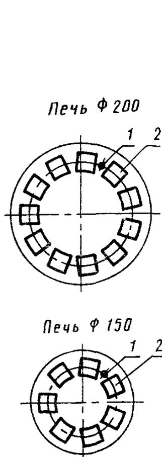
1 — термопара; 2 — образец
