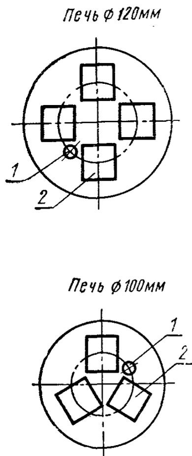
1 — термопара; 2 — образец
