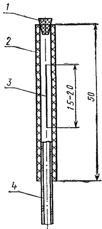
1 — пробка; 2 — резиновая трубка; 3 — щель; 4 — стеклянная трубка
