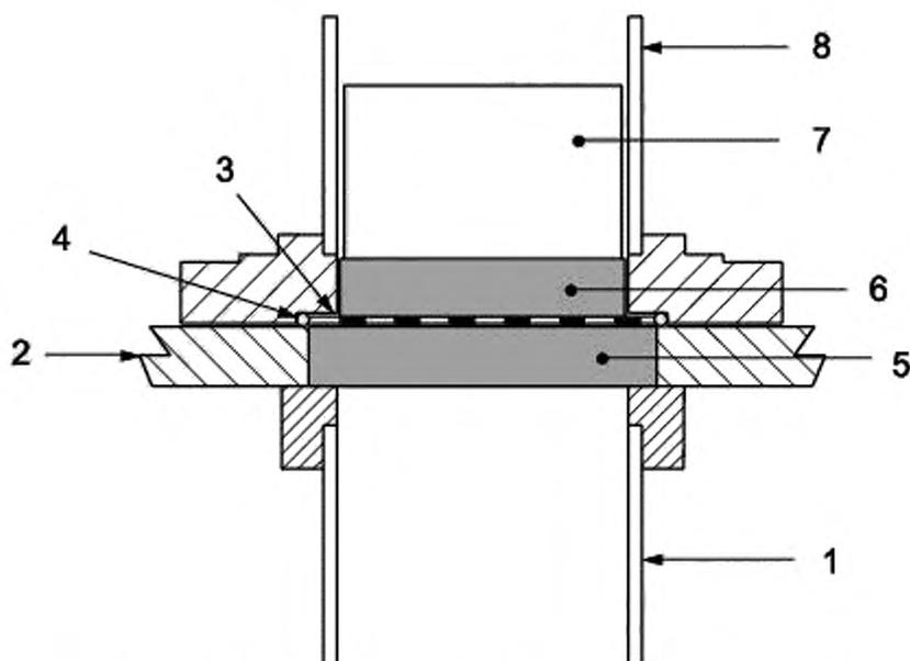
1 – стеклянная трубка; 2 – центральная пластина; 3 – образец; 4 – уплотнительное кольцо;
