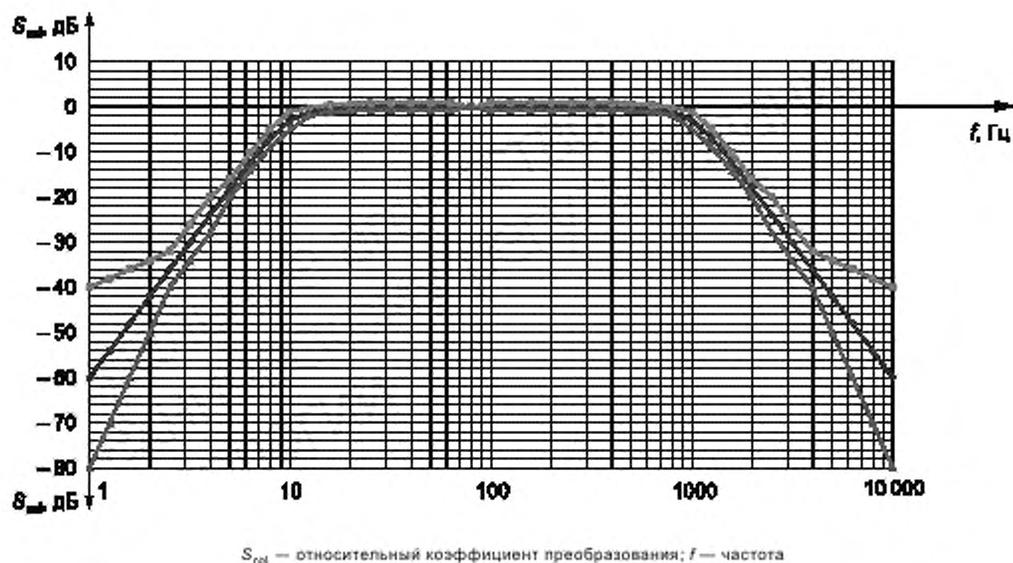
Рисунок 1 — Относительный коэффициент преобразования (в логарифмическом масштабе)
