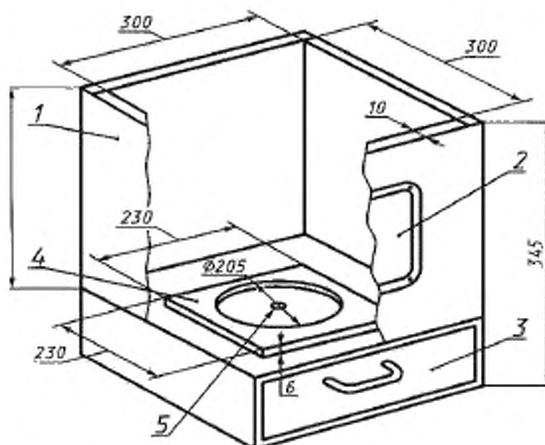
1 — испытательная камера; 2 — смотровое окно; 3 — выдвигаемое основание; 4 — металлическая пластина; 5 — место расположения источника воспламенения
