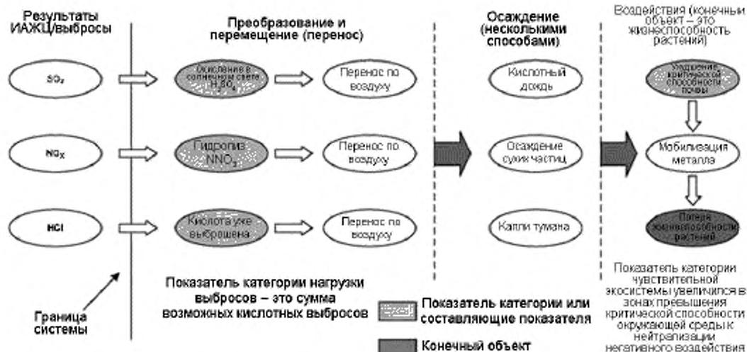
Рисунок 6 — Упрощенный экологический механизм закисления
