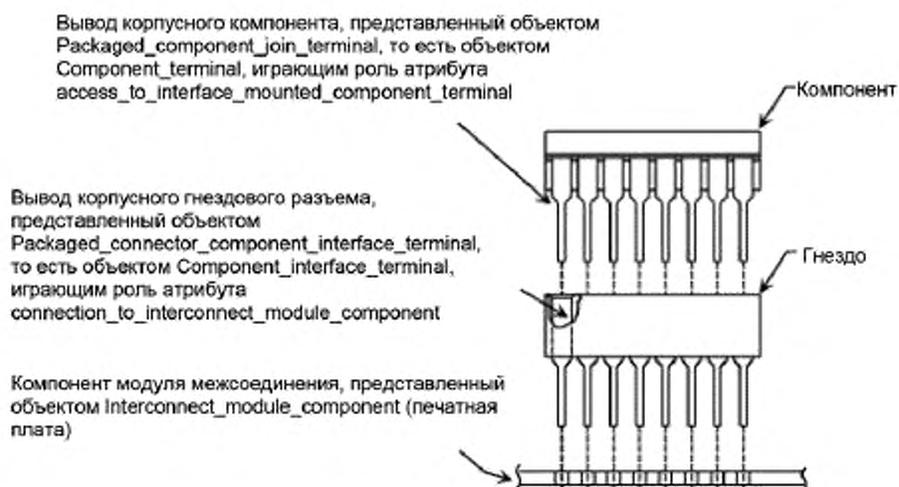
Рисунок 3 — Вывод корпусного компонента, представленный объектом **Packaged\_component\_join\_terminal**
