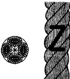
Рисунок 2 — Конфигурация 4-рядного крученного каната (тип В)
