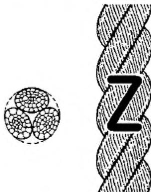
Рисунок 1 — Конфигурация 3-рядного крученного каната (тип А)
