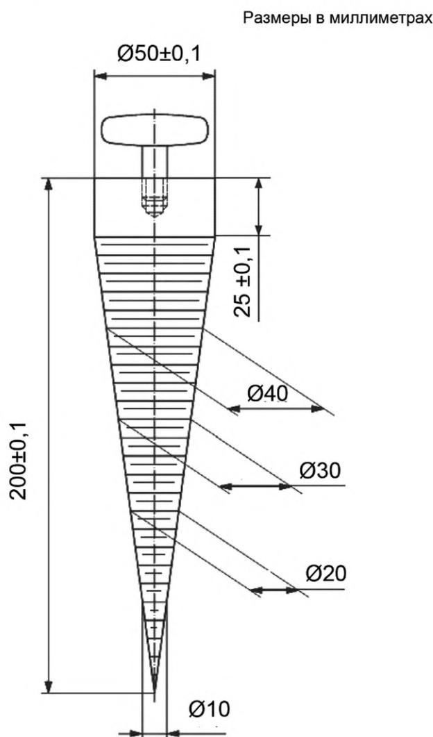
Рисунок 3 — Измерительный конус
