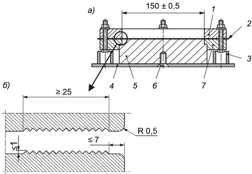
а) — зажимная система (обойма) с использованием направляющего блока; б) — поверхность зажимных колец
