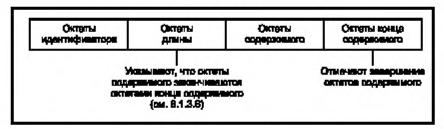
Рисунок 2 — Вариант составного кодирования
