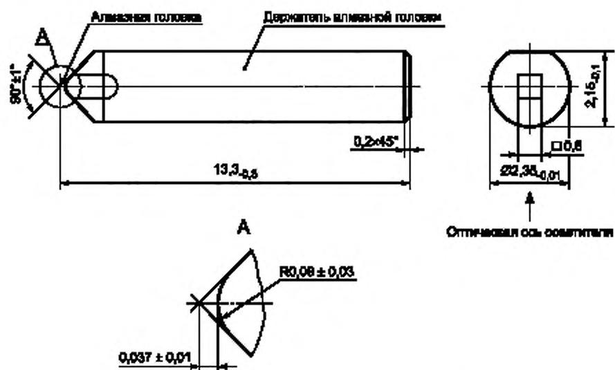
Примечание — Оптическая ось алмазного кристалла параллельна оси держателя.
