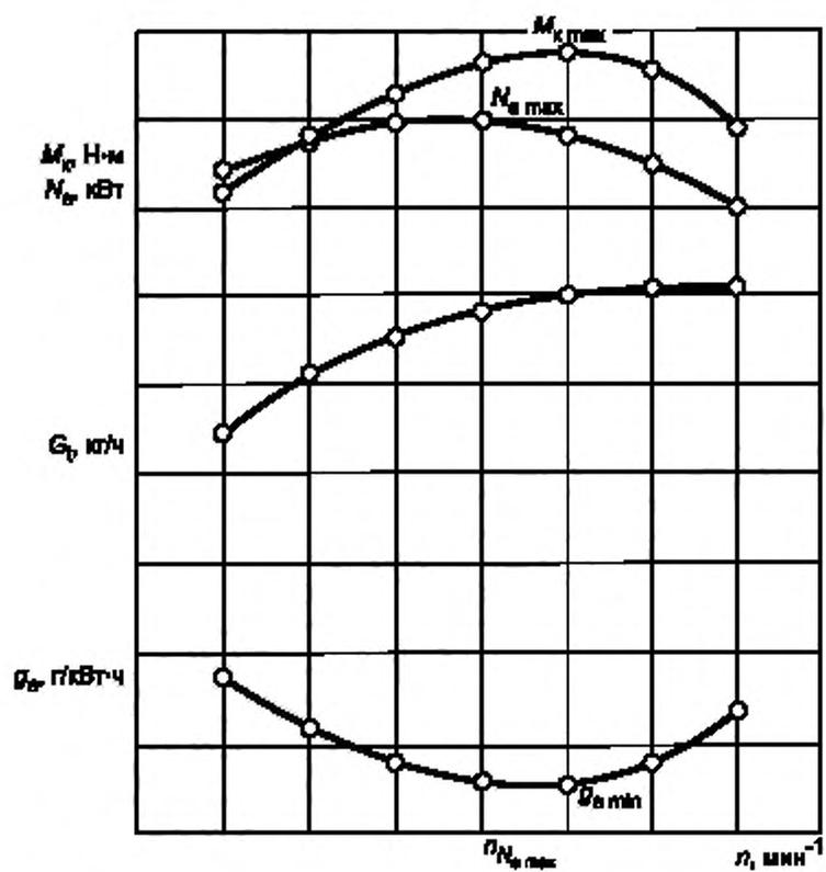
Рисунок Б.1 — Внешняя скоростная характеристика двигателя бензоинструмента
