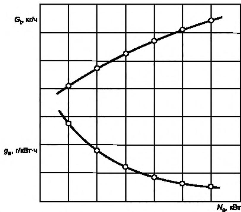
Рисунок Б.2 — Нагрузочная характеристика двигателя бензоинструмента при  $n = n_{\text{ном}}$
