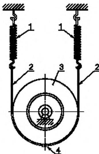
1 — пружина растяжения; 2 — гибкая лента; 3 — испытуемое тело; 4 — штифт
