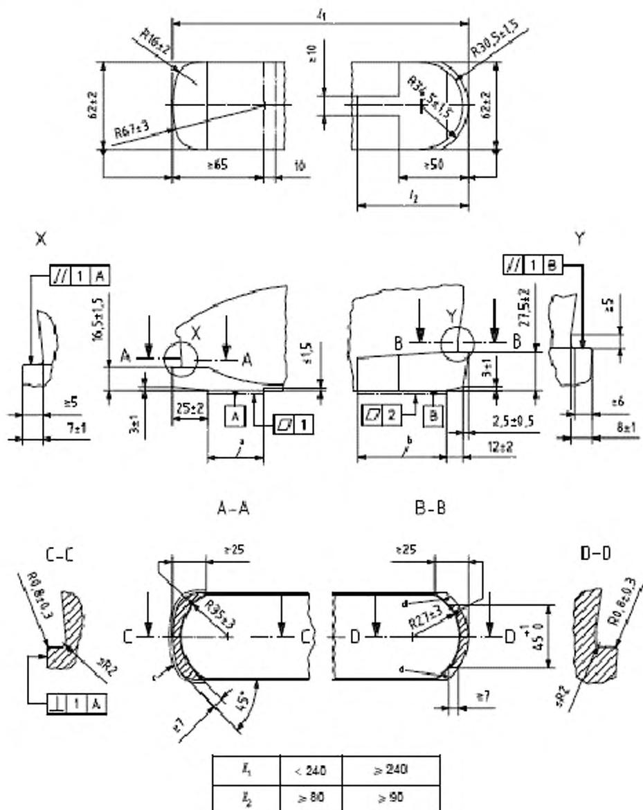
Примечание — Заштрихованы области, для которых действуют допуски ровности и размеры  $(16,5 \pm 1,5)$  мм  $(27,5 \pm 2,0)$  мм:
