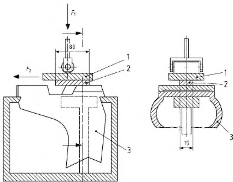
1 — опора элемента с низким трением, 2 — элемент с низким трением [с теми же характеристиками, что и в 4.3.9.2.2 b), за исключением ширины и длины, составляющими соответственно 15 и 80 мм],
