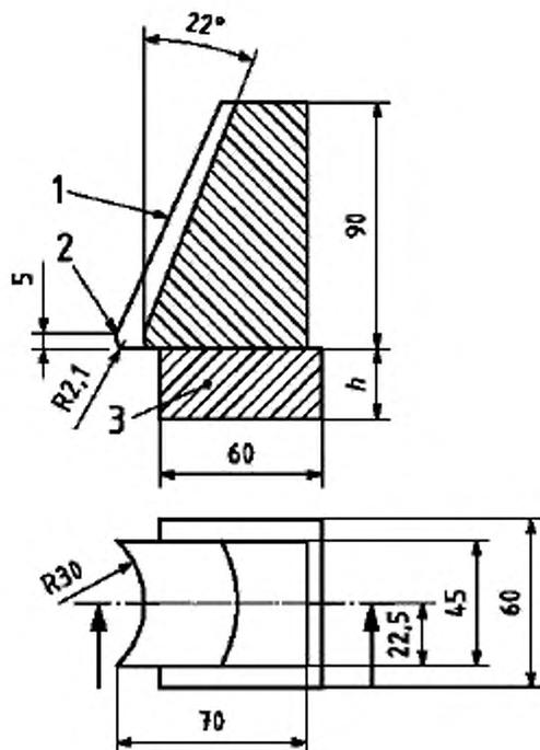
1 — конус (концентричен с цилиндром), 2 — цилиндр, 3 — подпорки, где  $h = 25,6; 27,6; 29,6$
