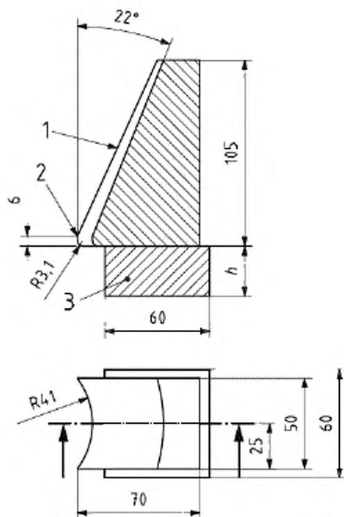
1 — кокус (концентричен с цилиндром), 2 — цилиндр, 3 — подпорки, где  $h = 29,1; 30,1; 31,1$
