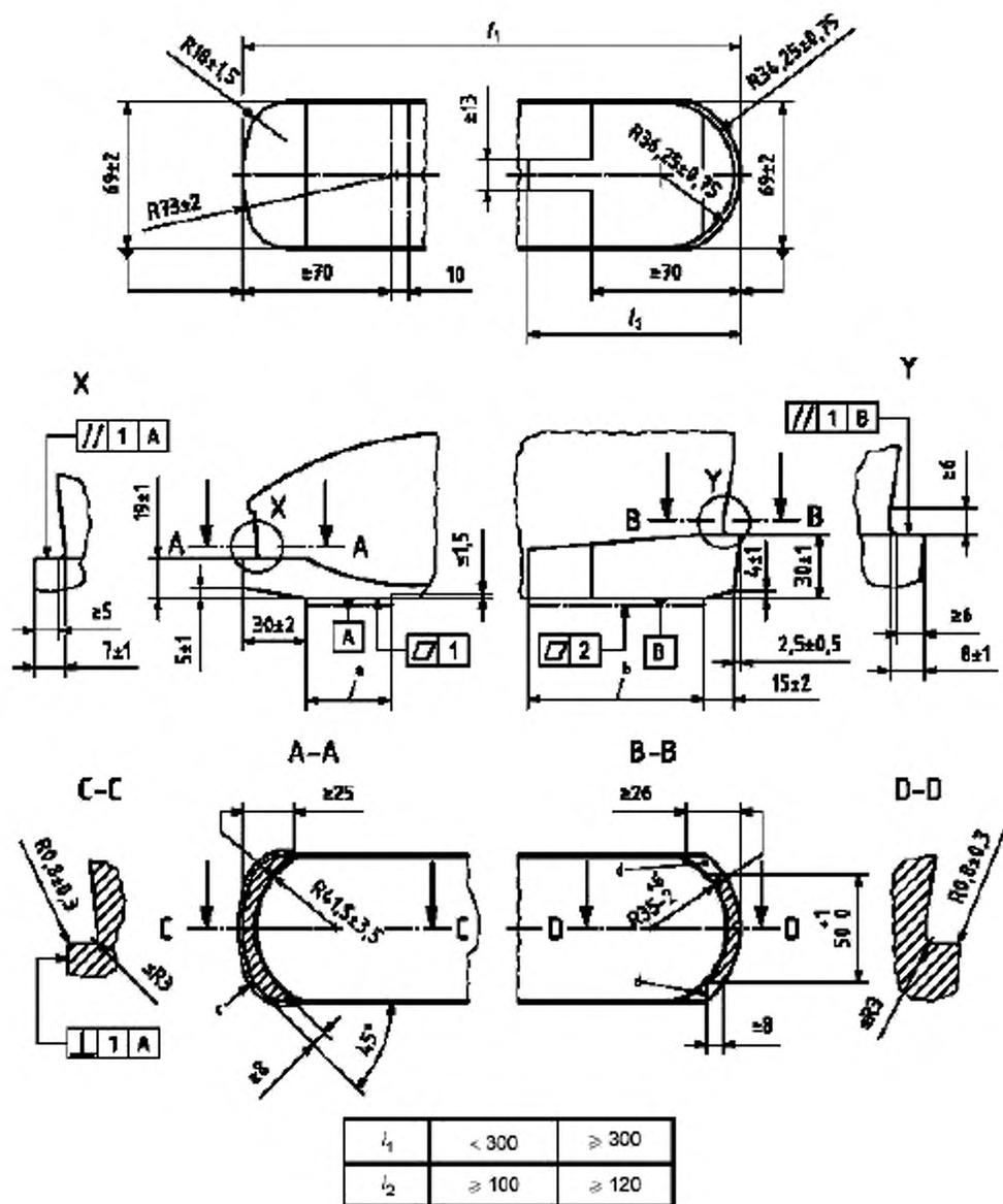
Примечание — Заштрихованы области, для которых действуют допуски ровности и размеры  $(19,0 \pm 1,0)$  мм и  $(30,0 \pm 1,0)$  мм:
