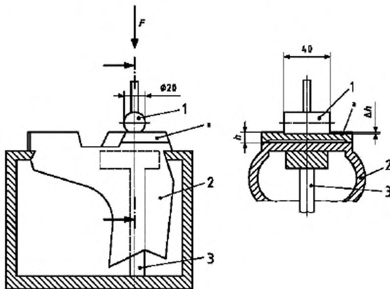
1 — испытательный цилиндр, 2 — образец ботинка, 3 — опора для предупреждения изгиба подошвы,  $F$  — испытательная нагрузка,  $h$  — опорная поверхность каблука
