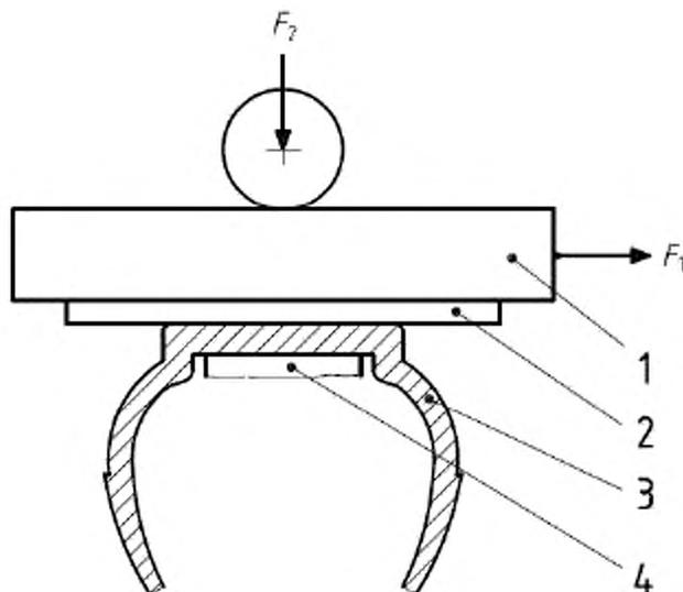
1 — опора элемента с низким трением, 2 — элемент с низким трением, 3 — образец ботинка, 4 — опора для предотвращения деформации ботинка,  $F_1$  — предварительная сила, требуемая для перемещения элемента с низким трением поверх зоны с низким трением,  $F_2$  — испытательная сила, прикладываемая к элементу с низким трением
