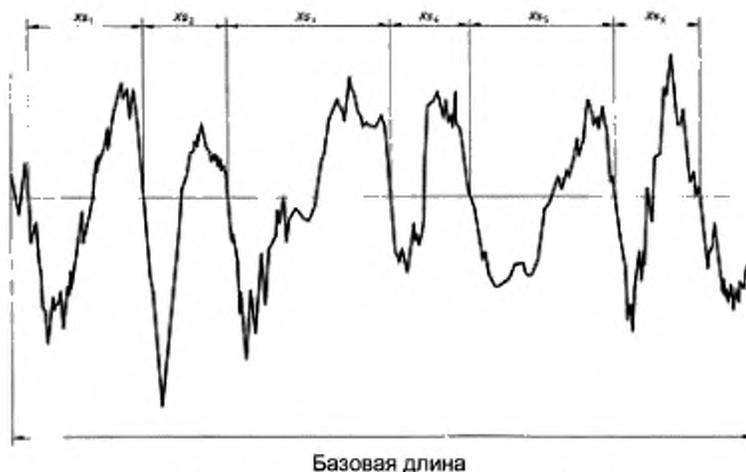
Рисунок 10 — Ширина элементов профиля
