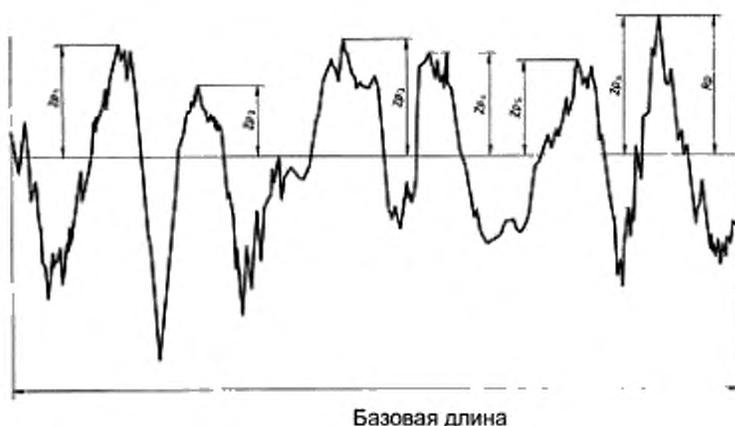
Рисунок 6 — Максимальная высота пика профиля (пример профиля шероховатости)
