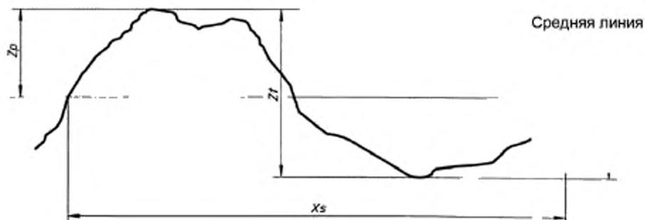
Рисунок 3 — Элемент профиля
