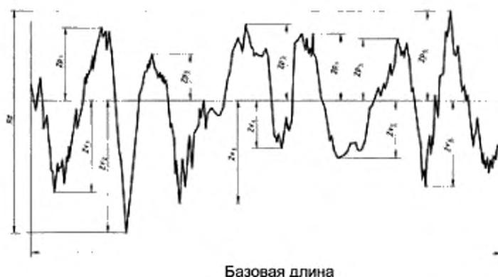
Рисунок 8 — Максимальная высота профиля (пример профиля шероховатости)
