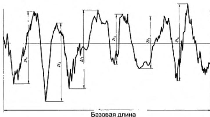
Рисунок 9 — Высота элементов профиля (пример профиля шероховатости)
