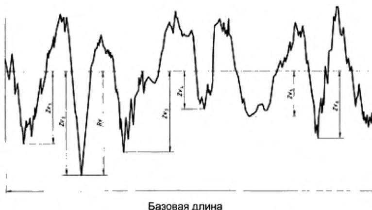
Рисунок 7 — Наибольшая глубина впадины профиля (пример профиля шероховатости)
