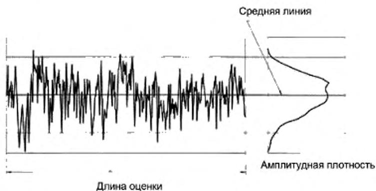
Рисунок 13 — Кривая распределения амплитуд высоты профиля
