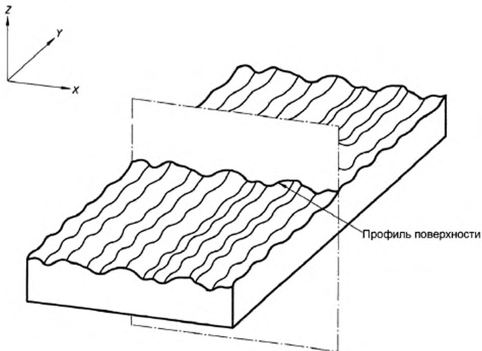
Рисунок 2 — Профиль поверхности
