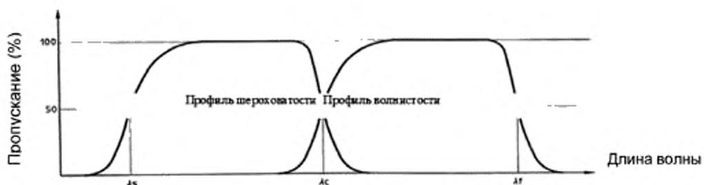
Рисунок 1 — Характеристики передачи профилей шероховатости и волнистости
