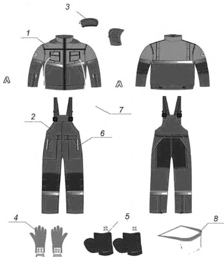
1 — электропроводящая куртка с капюшоном; 2 — электропроводящие брюки (полукомбинезон); 3 — электропроводящий накасник; 4 — электропроводящие перчатки; 5 — электропроводящая обувь; 6 — контактные соединения элементов комплекта; 7 — контактные проводники для соединения комплекта с потенциалом, на котором выполняется работа; 8 — экран для лица
