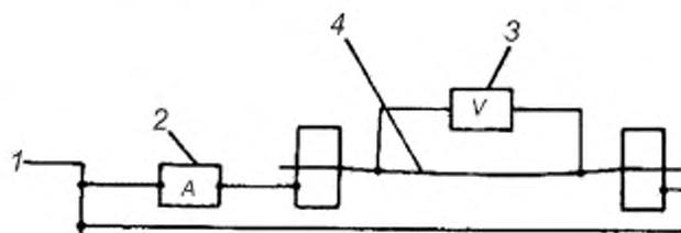
1 — источник тока; 2 — амперметр; 3 — вольтметр; 4 — испытуемый образец
