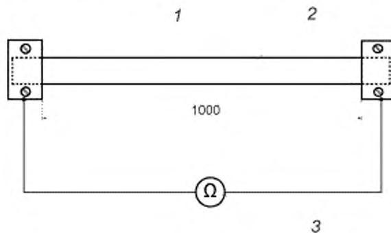
1 — разборные двоянные медные пластины; 2 — испытуемый образец; 3 — омметр
