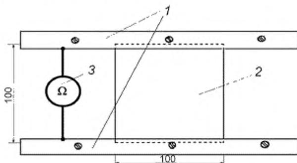
1 — пластины; 2 — испытуемый образец; 3 — омметр
