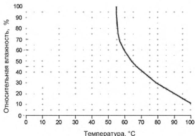
Рисунок 102 — Характеристика температуры/относительной влажности при ненормальной работе
