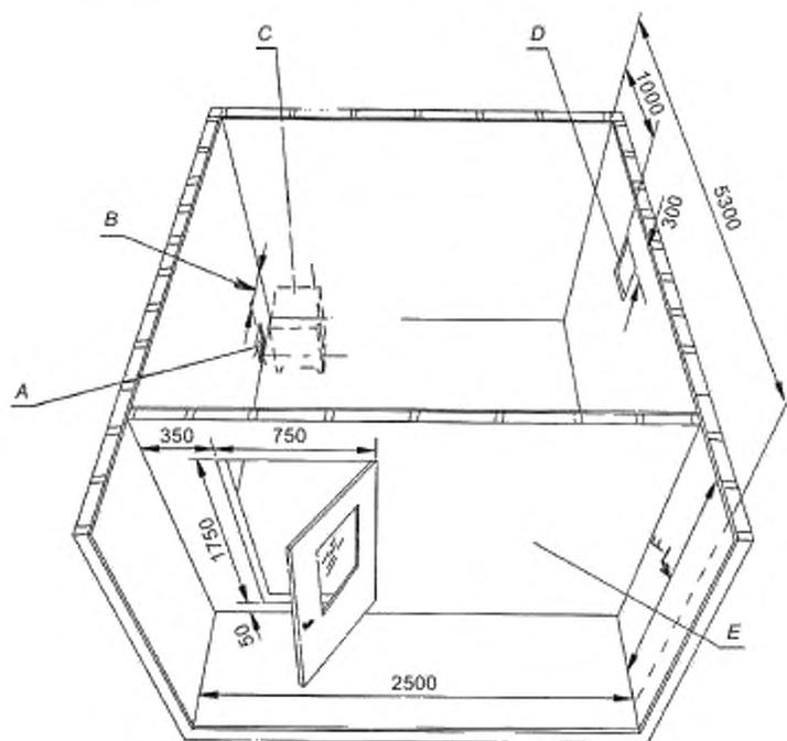
А — вход воздуха; В — регулируемое расстояние; С — **нагреватель для сауны**; D — выход воздуха,
