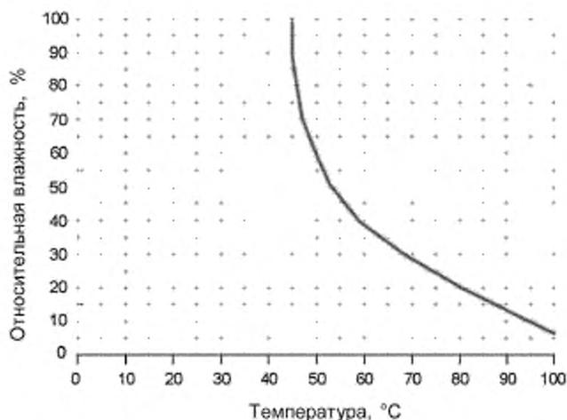
Рисунок 101 — Характеристика температуры/относительной влажности при нормальной работе
