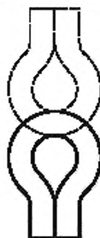
Рисунок 104 — Положения изгиба для шланга после извлечения из морозильного шкафа
