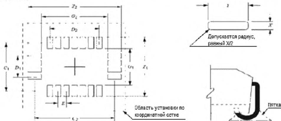
Рисунок 8 – Размеры посадочного места прямоугольного компонента QFJ, лист 1
